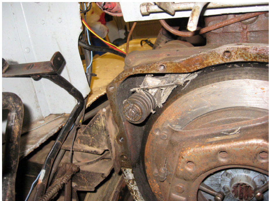
Ovenfor: Årsagen var at motoren på MT3 spandt fint, der var tilsyneladende bare ikke forbindelse i transmissionen til akslerne.
