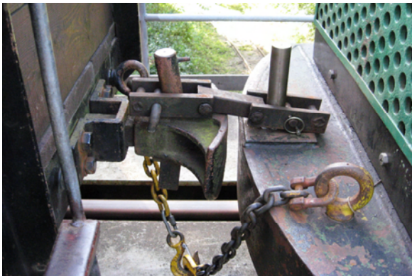
Ovenfor: MS15 blev forsynet med runde koblingshorn, så vi kan benytte korte koblinger og undgå de ryk det gav i vognene under kørslen.
